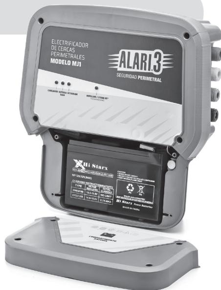
El frente del equipo incluye una indicación luminosa de **BAJA BATERÍA**, cuando la batería interna se descarga y su tensión baja de **12.0 VCC** se activa este indicador junto con una **señal sonora interna** pulsante lenta, ambas señales desaparecen cuando la batería toma carga suficiente desde el cargador interno y supera los **12.8 VCC**.
